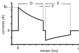
Exponencial truncada bifásica. Os parâmetros de formas de onda são ajustados automaticamente em função da impedância de desfibrilação do paciente. No diagrama à esquerda, D é a duração da fase 1, E é a duração da fase 2 da forma de onda, F é o atraso entre fases (500 µs) e Ip é a corrente de pico.
